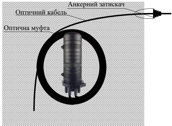
5.3 Закріпить муфту на стіні використовуючи комплект для кріплення, який іде в комплекті з муфтою. Запас кабелю повинен бути закріплений навколо муфти, як зазначено на малюнку.
